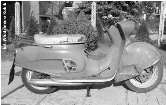
WFM Osa M50 Model silnika Typ S-06A (M50) dwusuwowy, gaźnikowy z zapłonem iskrowym, układ poziomy cylindra, pojemność 148 cm 3 , moc silnika 6,5 KM (4,8 KW), zużycie paliwa od 3, 3 do 4 l/100km
